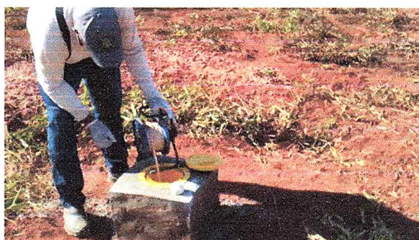
Foto 36 – Medição nível de água freática no PML 03
