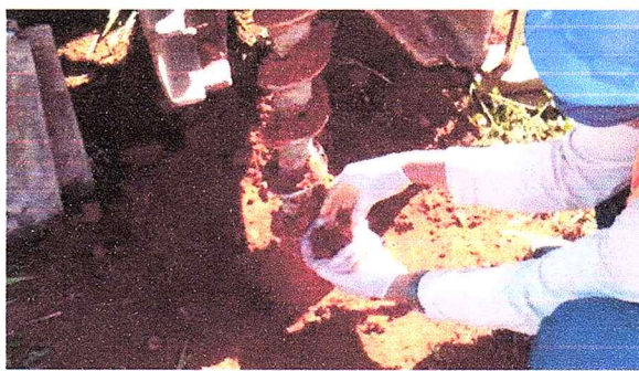
Foto 32 – Detalhe da coleta de solo do PML 03
