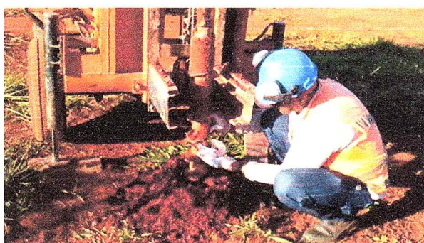
Foto 41 – Detalhe da coleta de solo do PML 04
