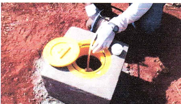
Foto 16 – Medição nível de água freática no PML 01
