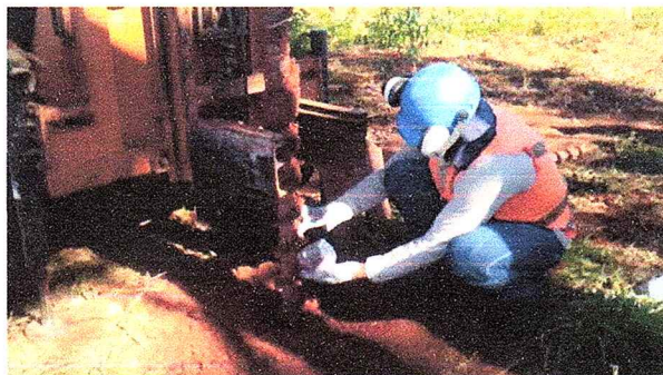
Foto 21 – Detalhe da coleta de solo do PML 02
