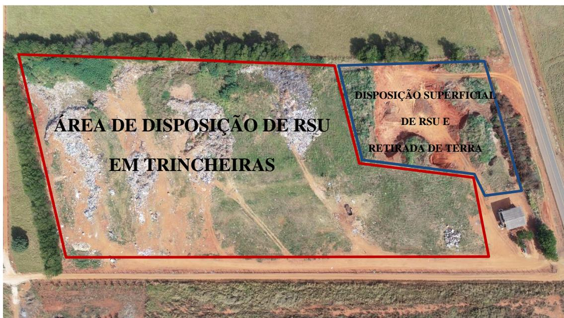
**Figura 13** Divisão as áreas de confinamento dos RSU do lixão.
